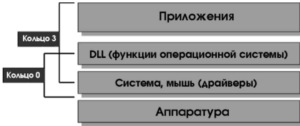
Рис. 2.1 Кольца 0 и 3 в модели защиты Intel
