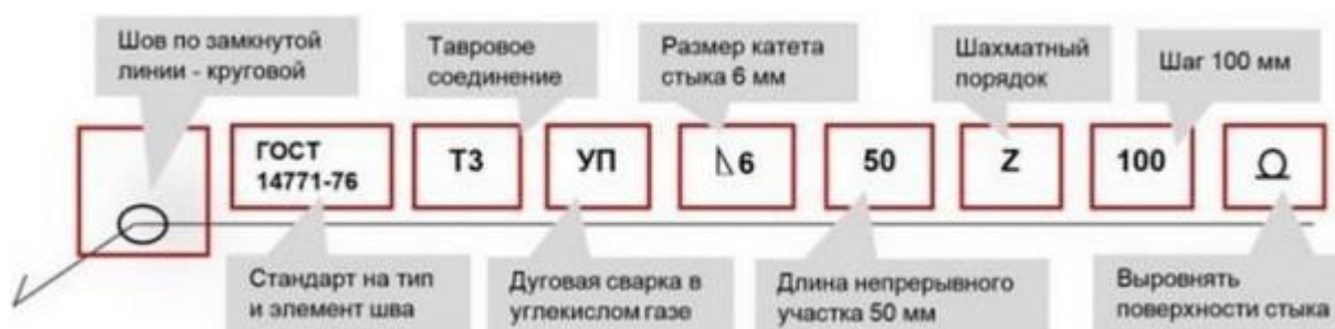
Рис.3 -Обозначение сварного соединения на чертеже.
