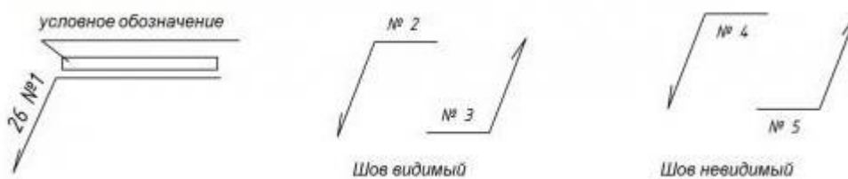
Рис.8 Обозначение одинаковых соединительных стыков
