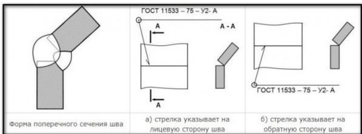
Рис.5 Шов, выполненный автоматической дуговой сваркой.
