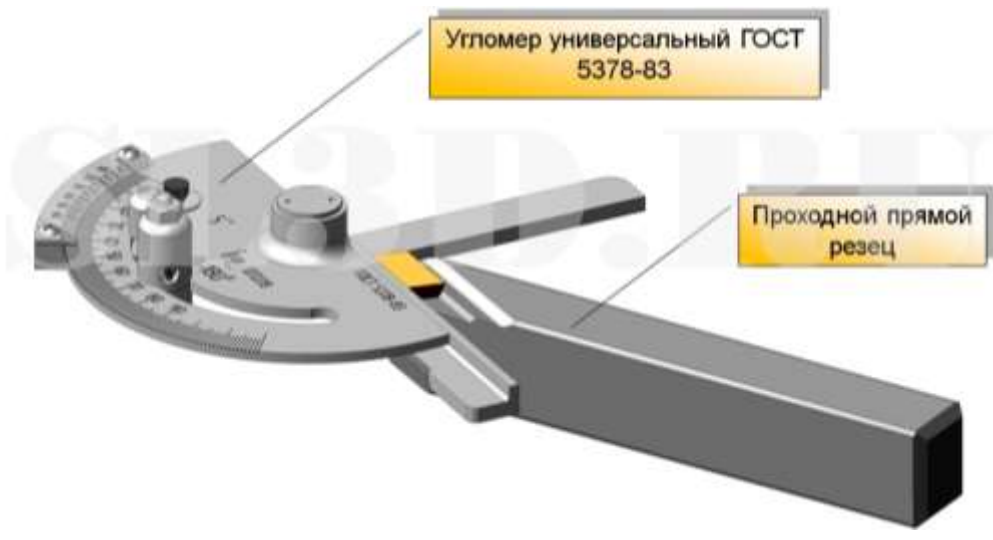
Рисунок 6 - Пример измерения резца угломером универсальным
