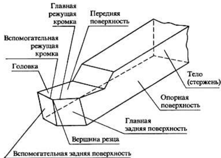
Рисунок 2 - Элементы конструкции токарного резца
