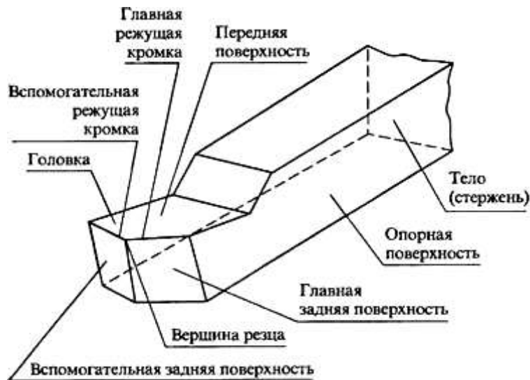
Рисунок 2 - Элементы конструкции токарного резца
