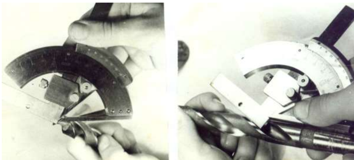
Рисунок 12 - Измерение углов сверла угломером
