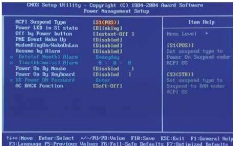
Рис. 8. Меню Power Management Setup утилиты CMOS Setup
