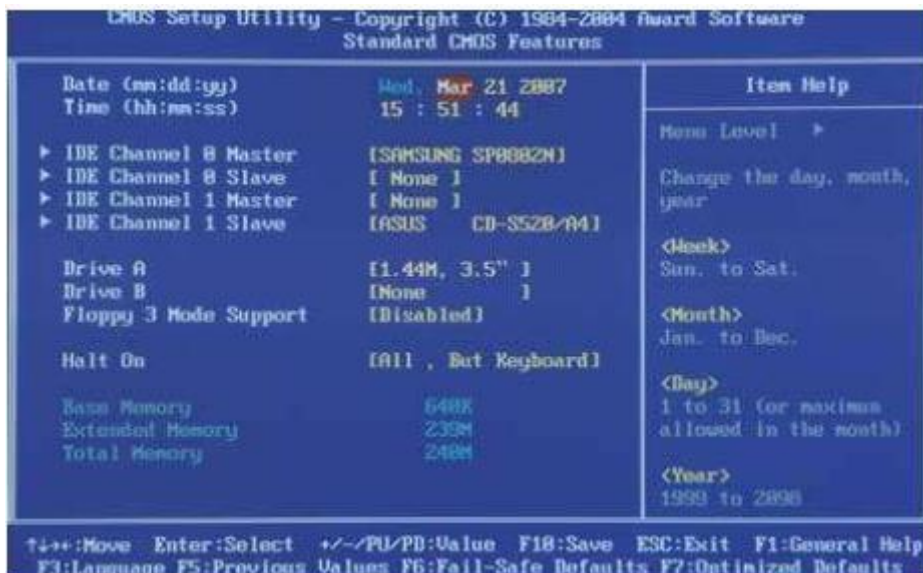
Рис. 3. Меню Standard CMOS Features утилиты CMOS Setup
