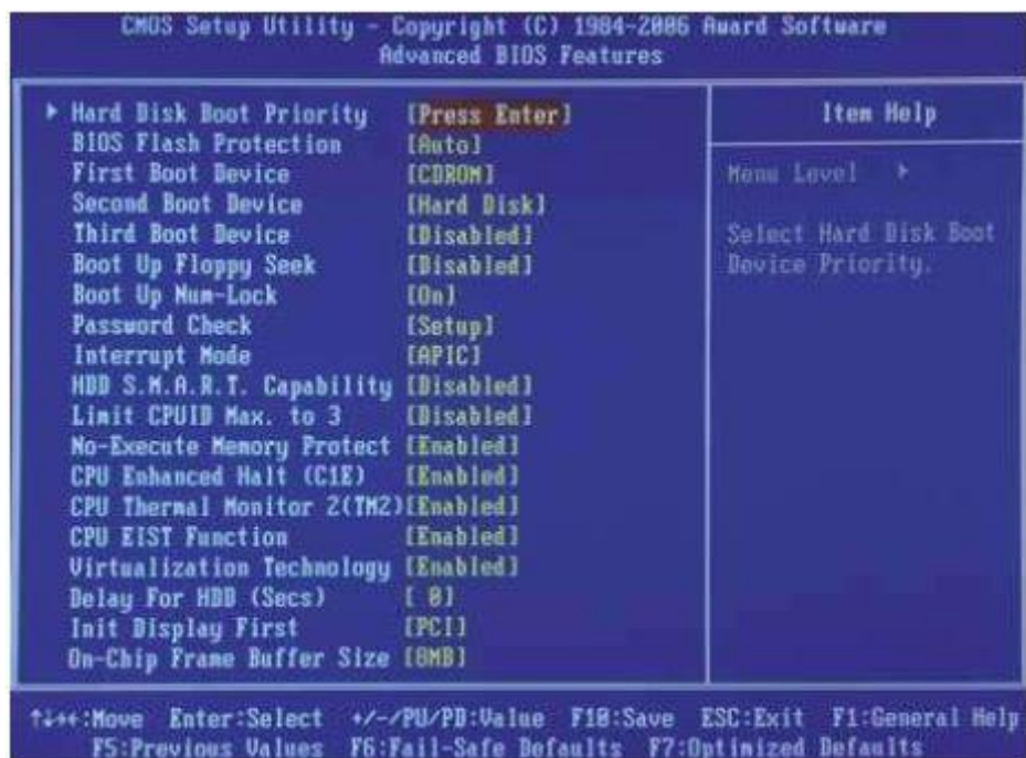
Рис. 4. Меню Advanced BIOS Features утилиты CMOS Setup
