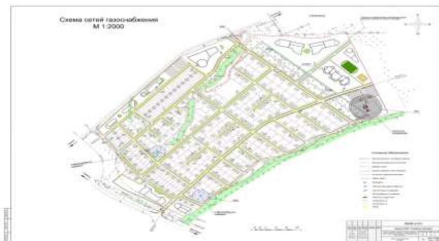
Рисунок 25 – Схема генерального плана сети газопровода
