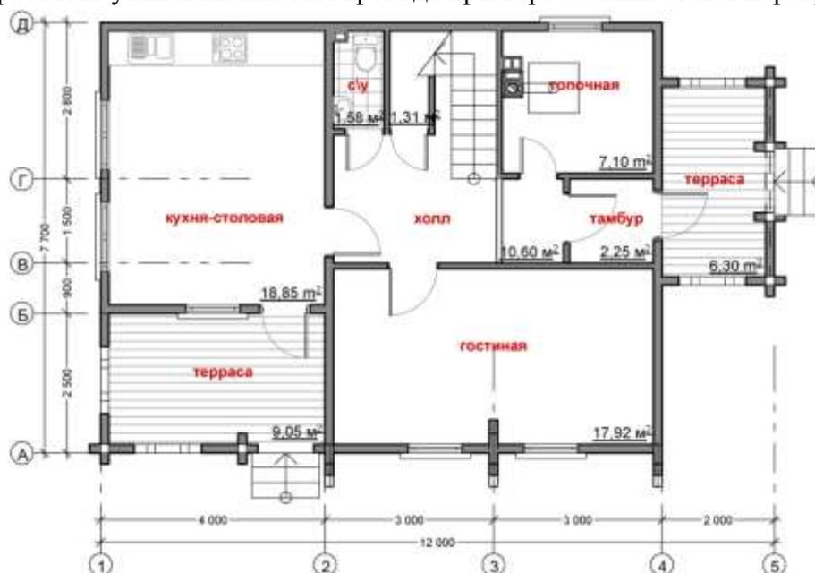
Рисунок 21 – Схема плана этажа жилого здания
