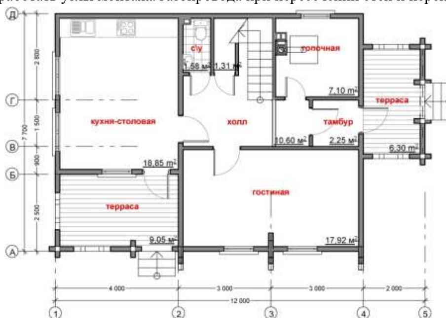
Рисунок 21 – Схема плана этажа жилого здания
