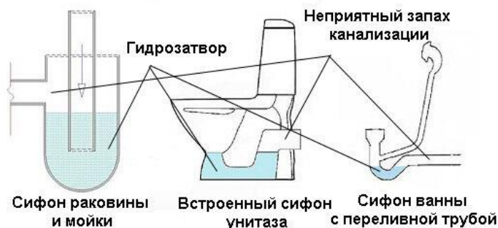
Принцип работы сифона (гидрозатвор)
