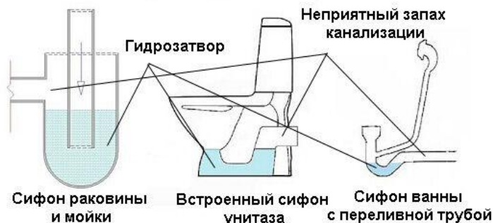
Принцип работы сифона (гидрозатвор)
